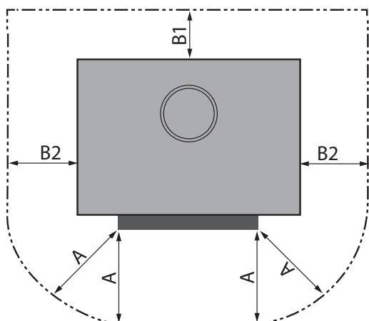
Distances de sécurité minimales à respecter par rapport à tout matériau de construction inflammable :
