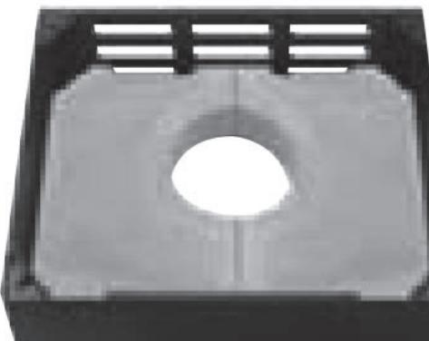
Die „E-Blok“ Erweiterungssegmente beinhalten einen Wärmespeicher aus Ofenbeton mit einer Dichte von 2,9 kg/dm<sup>3</sup>. Dieser Wärmespeicher sorgt für eine gleichmäßige Wärmeabgabe. Während des Heizbetriebes wird Wärmeenergie in der Speichermasse gespeichert. Nach dem Verlöschen des Feuers wird die so gespeicherte Wärmeenergie nach und nach gleichmäßig in den Aufstellungsraum abgegeben.
