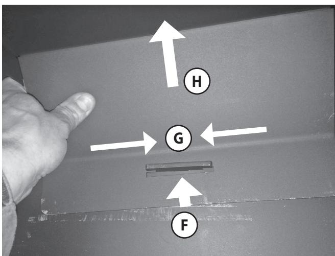
Die 4. Heizgasumlenkung ist mit einer Bajonetthalterung an der Decke im Inneren des Geräteturms befestigt.
