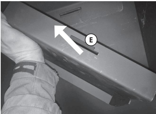
Au dessus se trouve un troisième déflecteur. Il est accroché sur l'arrière au corps de l'appareil également sur un support baïonnette
