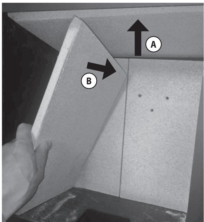
Über der 1. Heizgasumlenkung aus Vermiculite befindet sich die 2. Heizgasumlenkung (Stahl). Sie ist im vorderen Bereich in einer Bajonetthalterung eingehangen.
